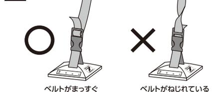
**5** ベルトにたるみがないように引っ張り調整します。
