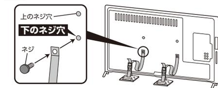
**3** キャッチプレートにマットを貼り、設置位置へ固定します。
